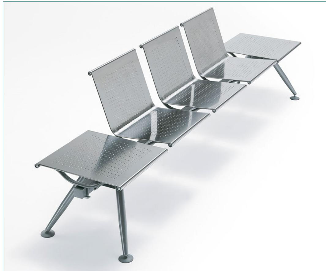
Sistema di sedute modulari con scocche e tavolini realizzati in lamiera di acciaio forata verniciata con polveri epossidiche oppure in acciaio inossidabile AISI 304 con finitura satinata. I supporti, le travi e le particolari basi coniche sono in acciaio verniciato con polveri epossidiche. Bracciolo in alluminio verniciato con polveri epossidiche.
