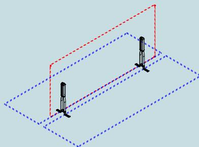
Coppia staffe con morsetto in acciaio verniciato con polveri epossidiche per fissaggio al piano della scrivania.
